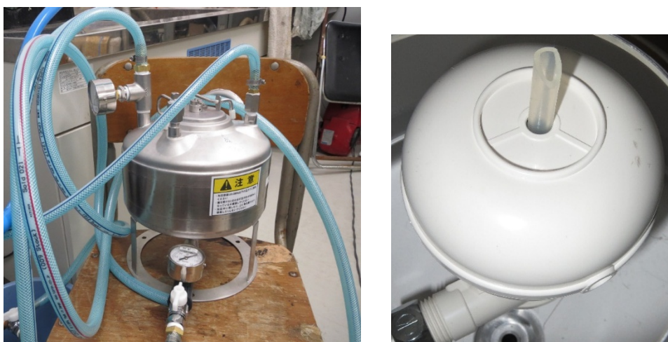
図3 新規開発の溶解装置（水位変動を全く考慮しなくて良いもの）左：外観、右：ノズル
