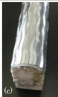
図 2 : サイン波状のリブレットパターン。
