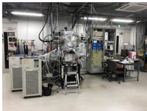
図1. ホームメイド型分子線エピタキシーシステム。北海道大学へ移管後、約1か月での立ち上げに成功した。分光を用いた分子線制御システムを擁するなど、純良な薄膜試料の作製に適している。
