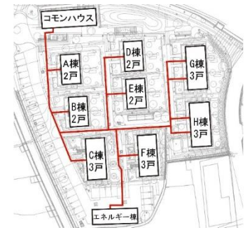
図1 住棟配置と熱供給配管図
