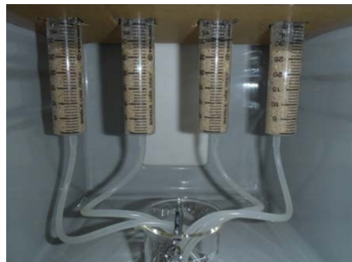
図-2 シリンジ室内加速固化試験
