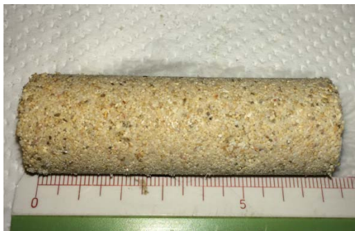
図-3 固化した砂供試体
