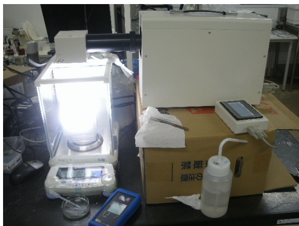
図1 水の蒸発量測定実験のセットアップ。電子天秤の上に多孔質グラフェンを浮かべた水溶液容器を置き、その容器を断熱材で覆い、上方から擬似太陽光 1000 \text{ W/m}^2 (夏場の太陽光の強さ) を照射している状況。蒸発した蒸気 (つまり浄化された蒸気) は密閉容器中で回収が可能であるが、密閉容器を使った実験の前に作成した試料の性能評価を優先した。
