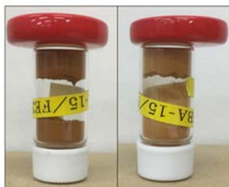
図 2 触媒の磁気応答性 (左: 反応前、右: 反応後)
